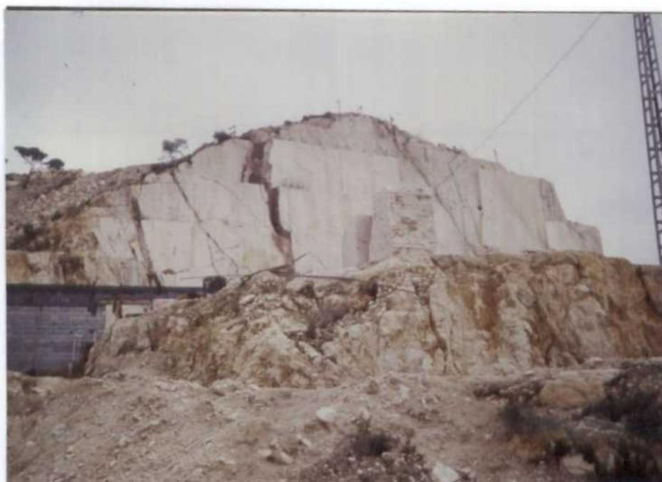
Conformación de un frente de explotación en bancos de 4 y 6 m.
